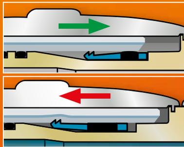
Beim Einschleiben des entgrateten Rohres gibt der Grip-Ring den Weg frei. Bei Zug oder Druck gräbt er sich tief in das Rohr und hält es sicher in der Verbindung.
