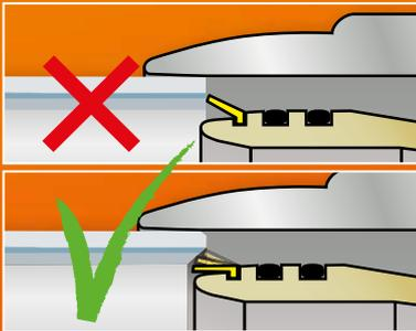
Der PROTECTOR-Ring verhindert das Einschleiben nicht-entgrateter Rohre. Das ist das Sicherheitsplus für den Anwender, Montagefehler sind damit ausgeschlossen.
